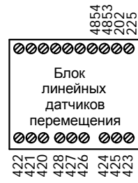
Клеммная колодка шкафа управления A4
